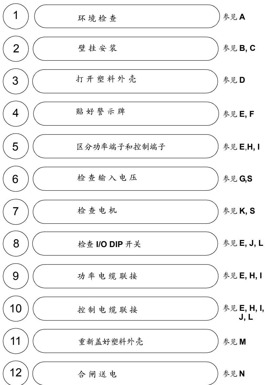
图 1 ACS400 分步安装示意。详细说明见相应的章节。
